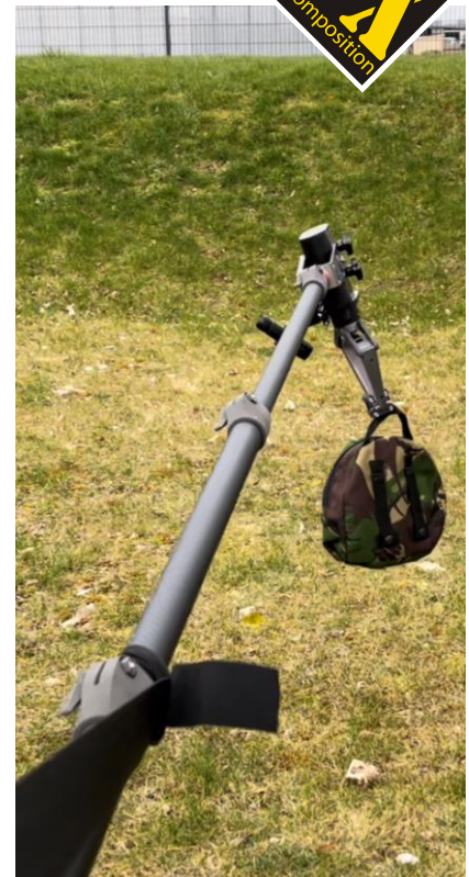
Manipulierstange beim Heben eines verdächtigen Gegenstandes
