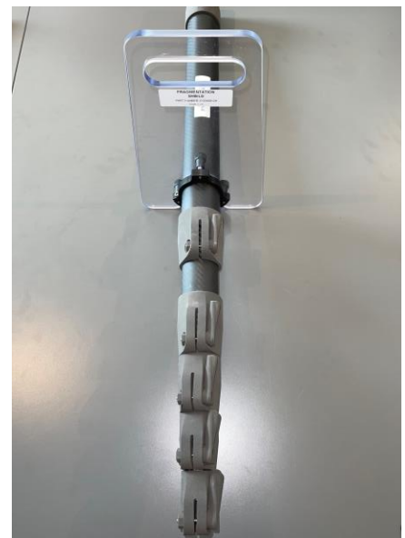
Manipulierstange, vorderer Bereich, zusammengesoben, mit montiertem Handschutz
