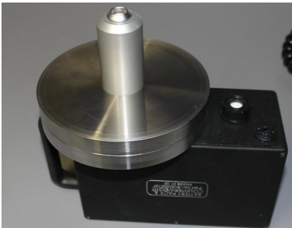
Gegengewicht / Batteriebaugruppe mit Zusatzgewichten
