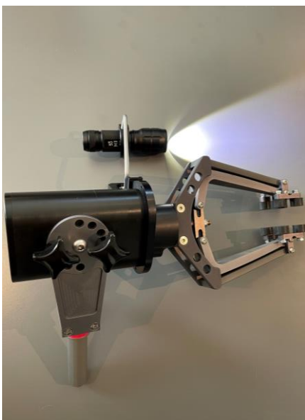
Zangenbaugruppe mit abnehmbarer Beleuchtung am Gelenkarm
